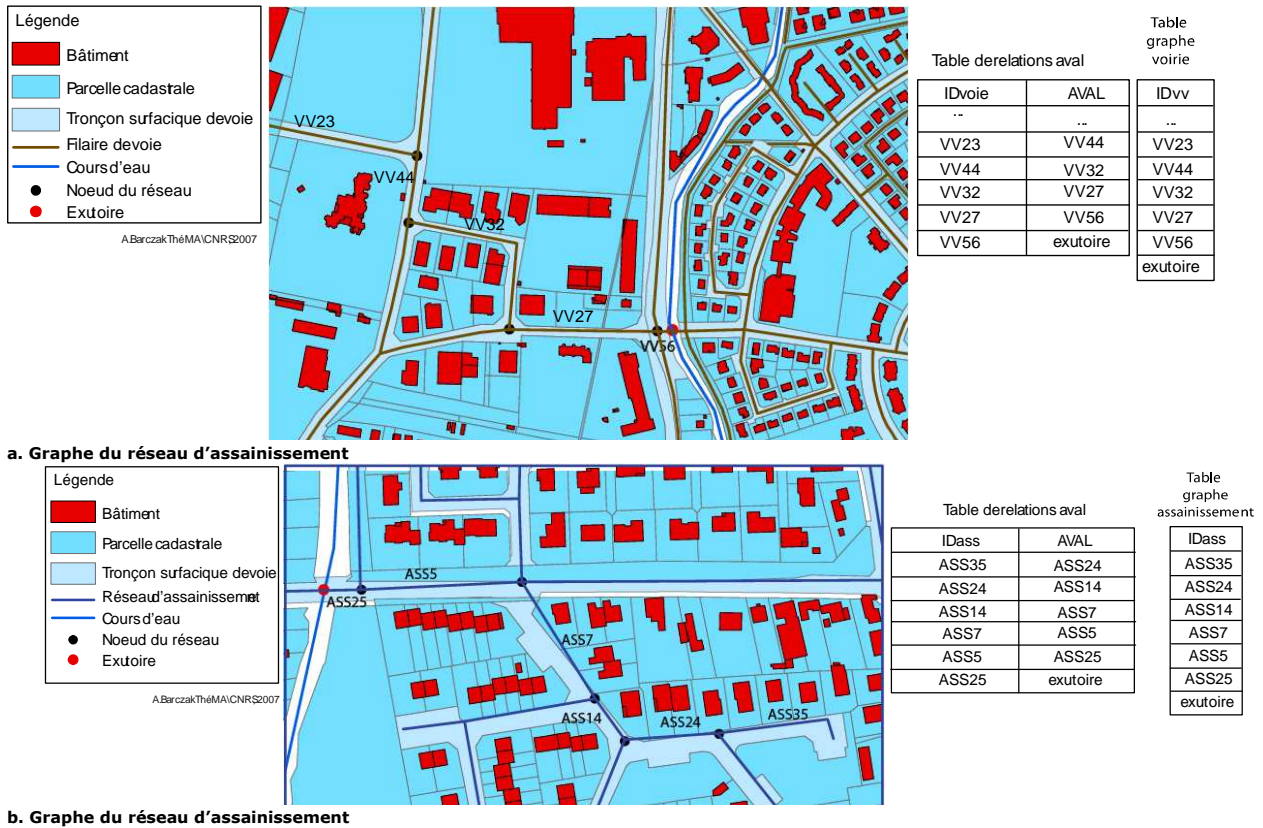
Figure 4. Circulation de l'eau en fonction de la morphologie urbaine et graphe de la voirie
